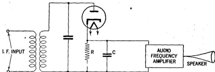
FIG. 21—Diode detector circuit.
