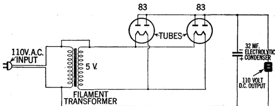
FIG. 16—A simple 110 volt-a.c./110 volt-d.c. rectifier unit.
